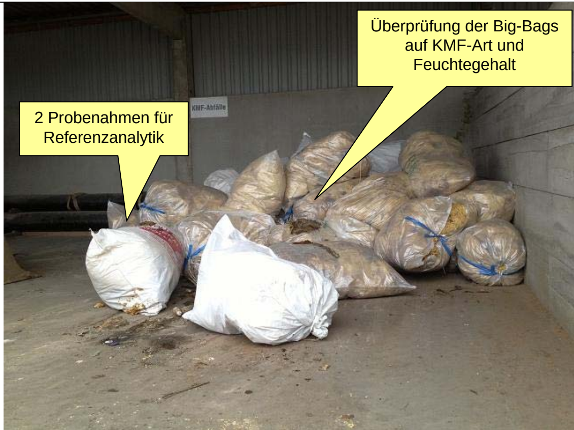
Bild 12: Lagerung der gepressten KMF-Abfälle im Außenbereich
