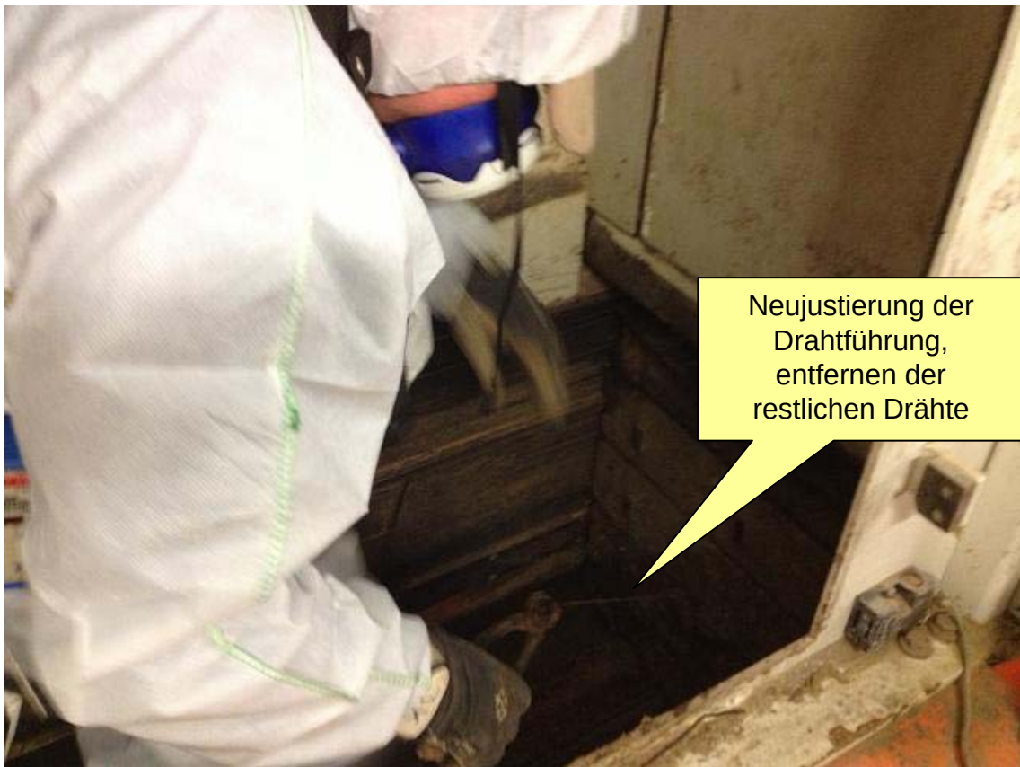
Bild 6: Drahtproblem; Arbeiten innerhalb der Presse durchgeführt (Nr. 6)
