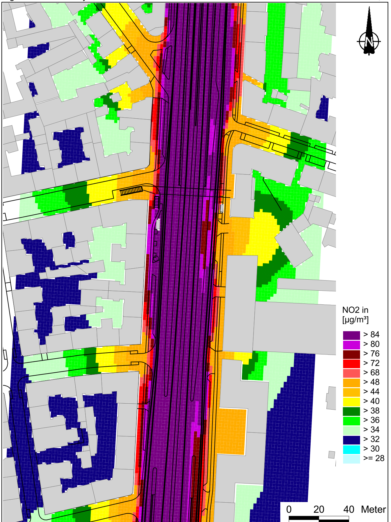
Abb. 6.8: NO 2 -Gesamtbelastung (Jahresmittelwerte) für die Variante V2 (Tempolimit 50 km/h, nicht überwacht) in ca. 1.5 m Höhe ausgedrückt in \mu\text{g}/\text{m}^3 . Gebäude sind hellgrau und Straßen als schwarze Linien eingezeichnet
