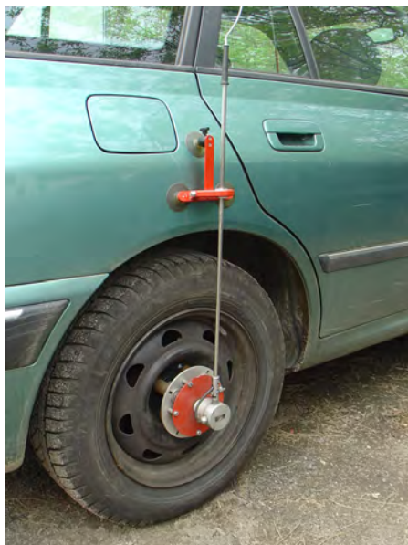
Abb. 5.1: Messfahrzeug mit angebautes Peiseler-Messrad
