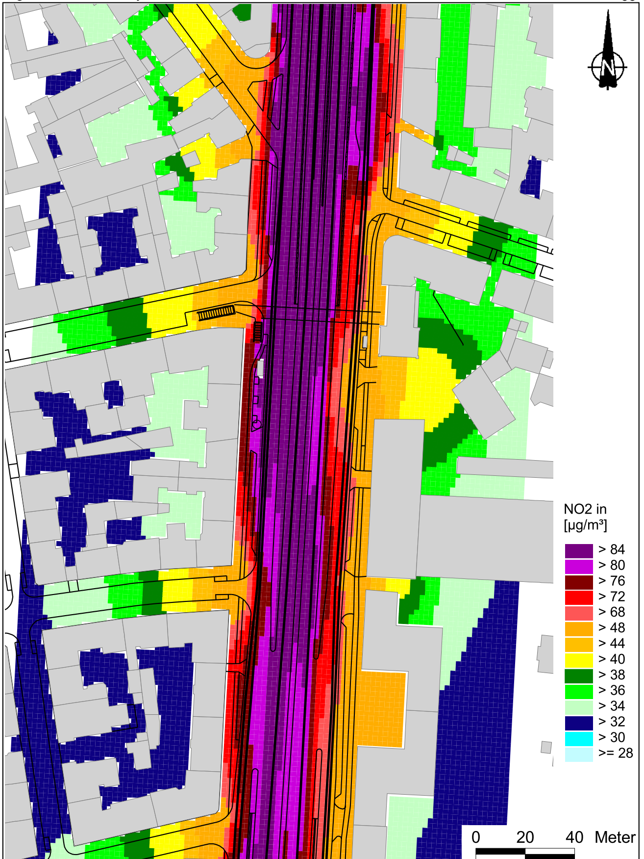
Abb. 6.1: NO 2 -Gesamtbelastung (Jahresmittelwerte) im Ist-Zustand 2011 in ca. 4 m Höhe ausgedrückt in \mu\text{g}/\text{m}^3 . Gebäude sind hellgrau und Straßen als schwarze Linien eingezeichnet
