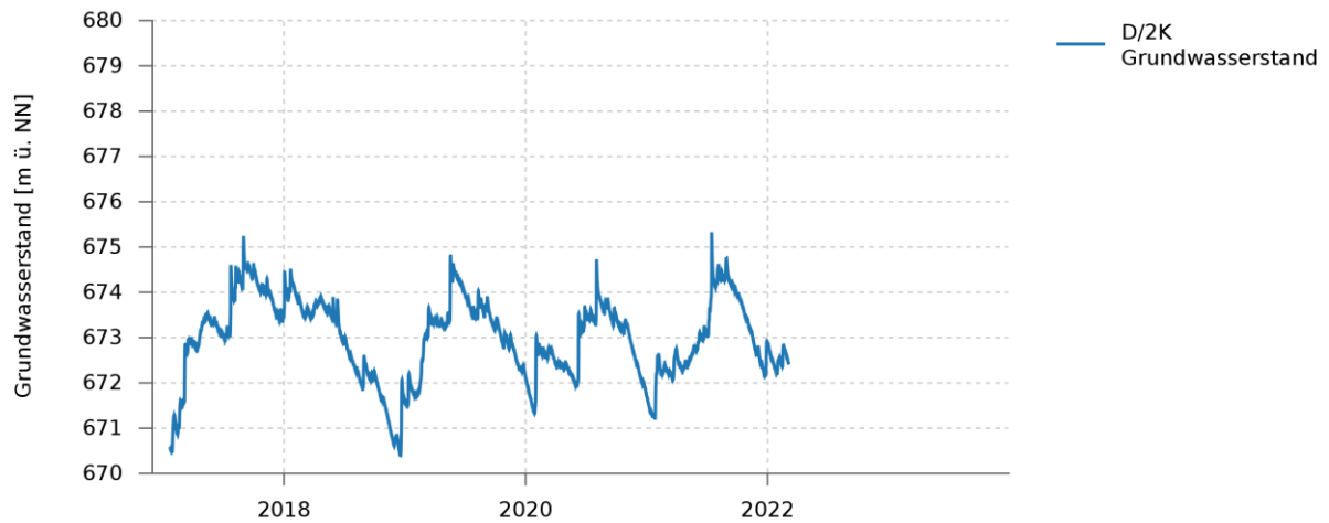
Abbildung 3.5: Gemessener Grundwasserspiegel im in GWK 1_G096 Quartär-Penzberg im mehrjährigen Verlauf
