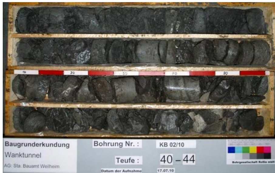
Abbildung 5: Tektonisch beanspruchte Gesteine der Partnach-Formation im Bohrkernaufschluss.
