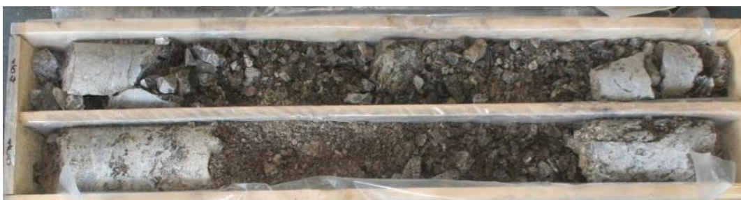
Abbildung 29: Bohrkern aus der Bohrung KB 14(s)/11 (154-156 m) mit kakiritischen Lagen (mittig) in einer kataklastischen Störungszone (randlich).
