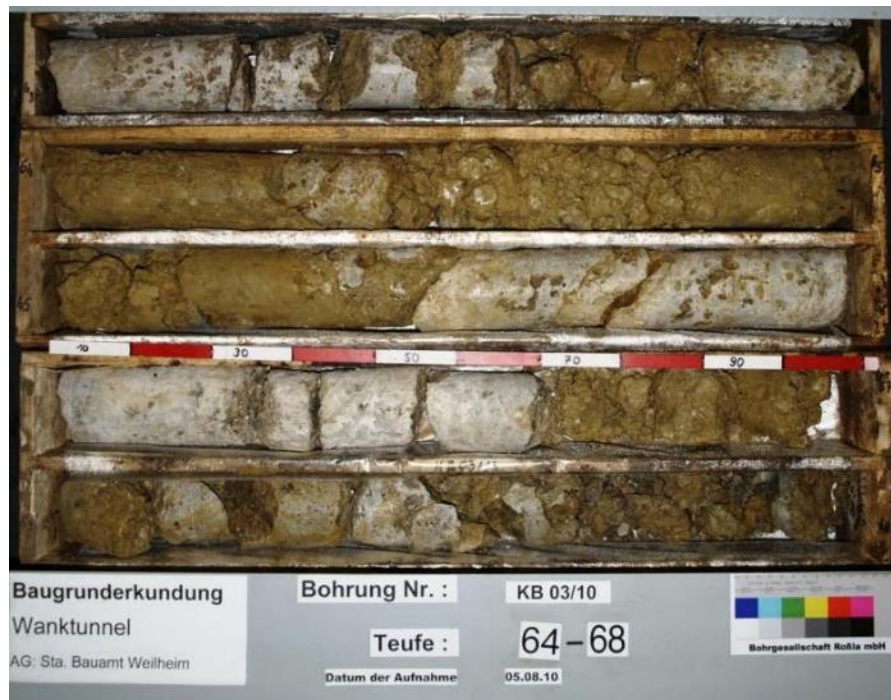
Abbildung 11: Hellbraune Karstfüllungen in Rauwacken der Oberen Serie in der Bohrung KB 03/10 (64-68 m).
