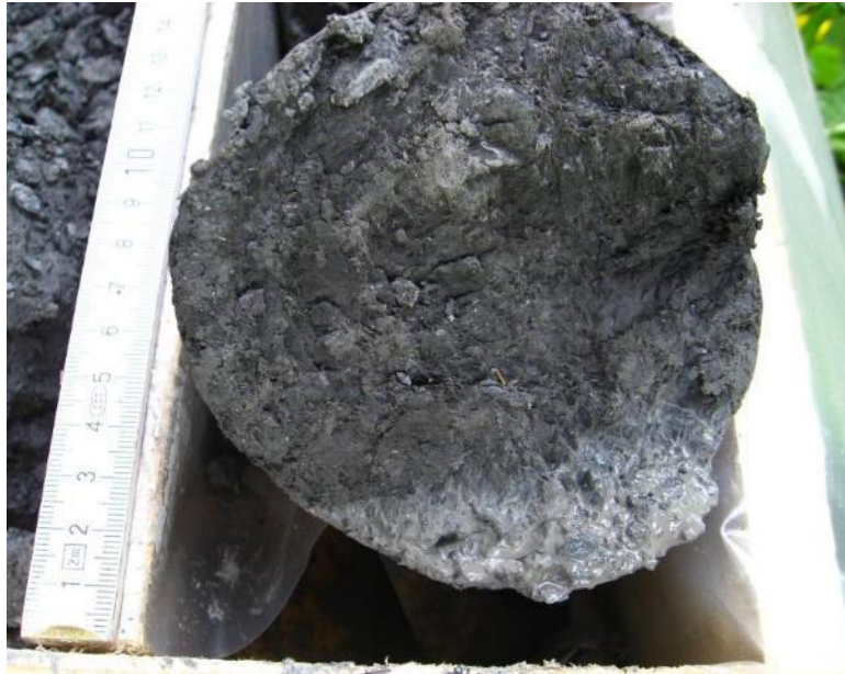
Abbildung 27: Von zahlreichen Trennflächen durchzogene Raibler Schiefertone aus Bohrung KB 14(s)/11 (35 m Tiefe).
