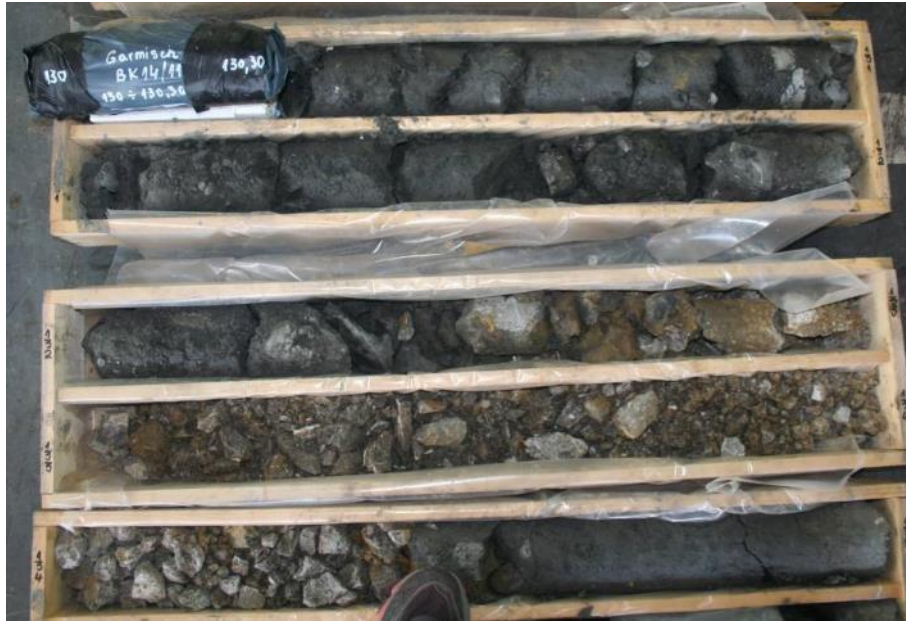
Abbildung 33: Störungszone mit kalkstein- und tonsteinbetonten Abschnitten. Die Tonsteinabschnitte weisen Bimrock-Strukturen auf (KB 14s()/11, 130-135 m).
