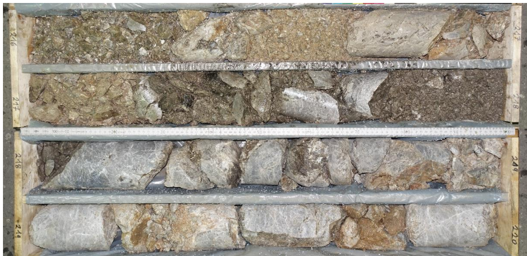
Abbildung 13: Störungszone in der Hauptdolomit-Formation mit Kakirit- und Katakilasitzone (KB 22(s)/22 216-220 m).
