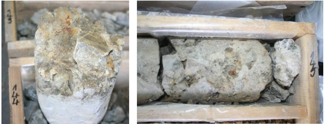
Abbildung 30: Störungsbrekzie in Kalkstein (Kataklasit): durch calcitische Ausfällungen wieder- verteilte Kalkbruchstücke (KB 14(s)/11, 144-145 m).
