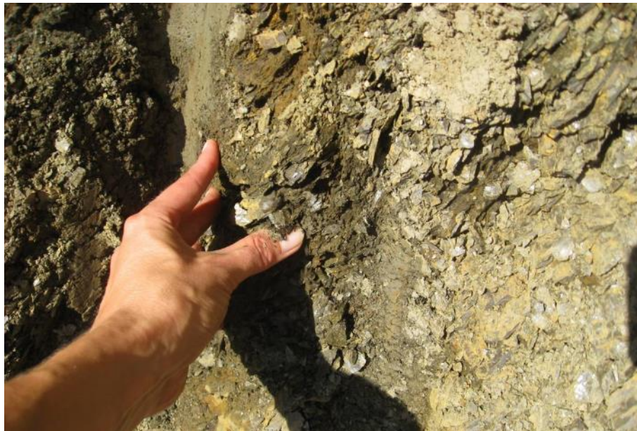
Abbildung 4: Bräunlich verwitterte und blättrig zerlegte Schiefertone der Partnach-Formation im Oberflächenaufschluss am Bohransatzpunkt von KB 16(s)/11.
