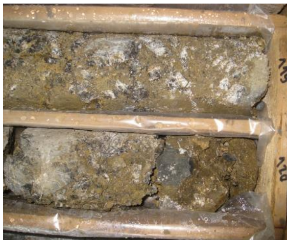
Abbildung 34: Bimrock-Struktur in Bohrung KB 14(s)/11 (119/120m und 131/132m).
