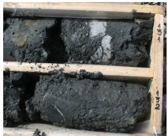
Abbildung 34: Bimrock-Struktur in Bohrung KB 14(s)/11 (119/120m und 131/132m).
