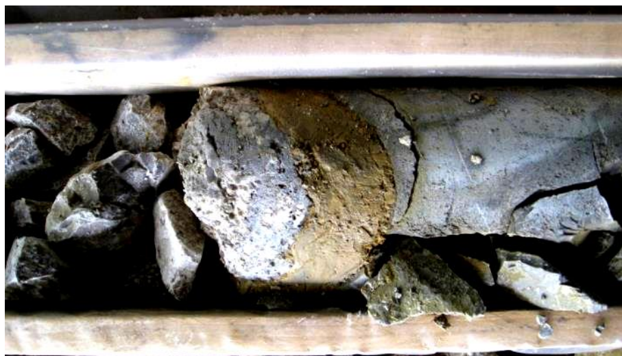
Abbildung 36: 3-4cm mächtige, braune, tonige Paläokarstfüllung mit steifer Konsistenz in einer Kluft in Raibler Kalken (KB 14(s)/11, 140,6 m).
