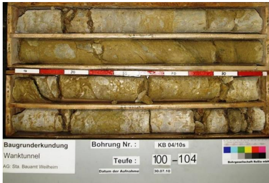
Abbildung 35: Erbohrter Paläokarsthohlraum KB 04(s)/10.
