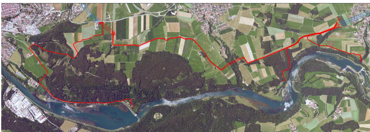
Abbildung 9: Alternative Verkabelung Schongau-Kinsau
