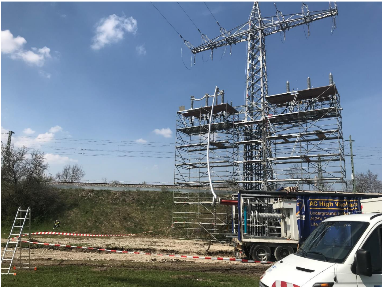
Abbildung 24: Hochspannungsprüfung am Mast
