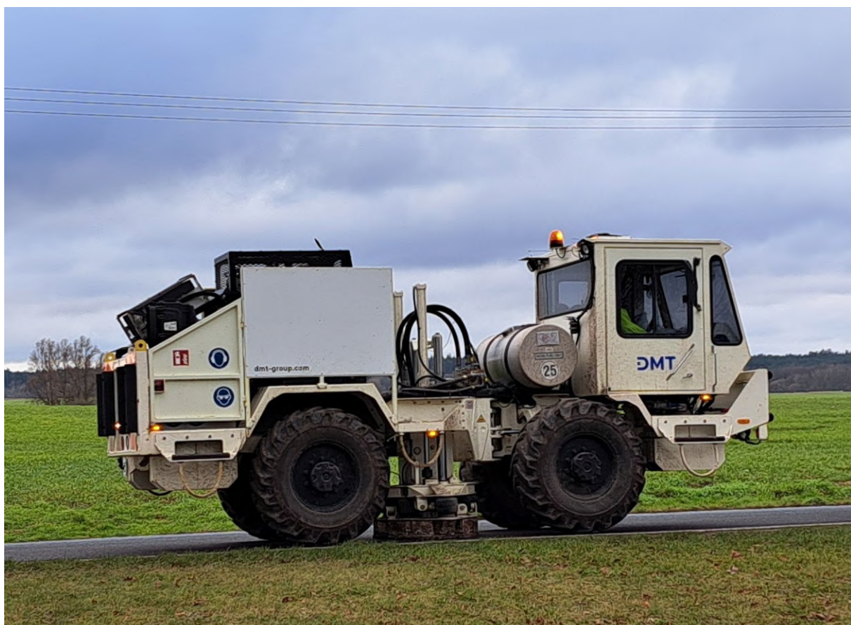
Abbildung 4: Beispiel Vibratorfahrzeug INOVA Univib mit der Vibratoreinheit PLS-326.
