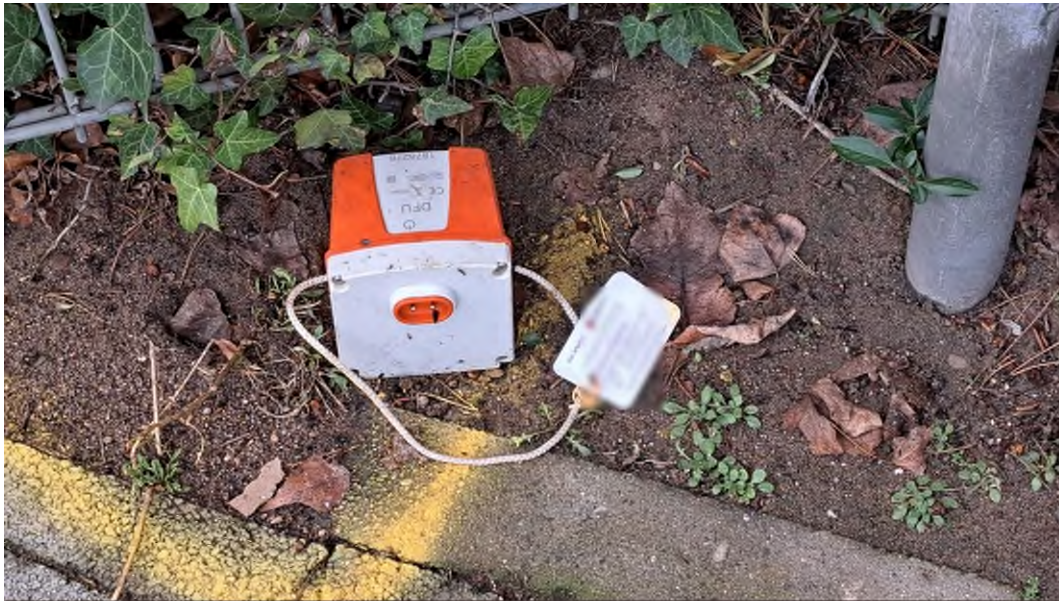
Abbildung 2: Mess- und Registriereinheit Sercel WiNG auf Basis von MEMS als Einzelsensoren. Der an der Trageschleife befestigte Zettel enthält Informationen über den Eigentümer des Sensors, den Auftraggeber und die seismische Messung (z.T. per QR-Code).
