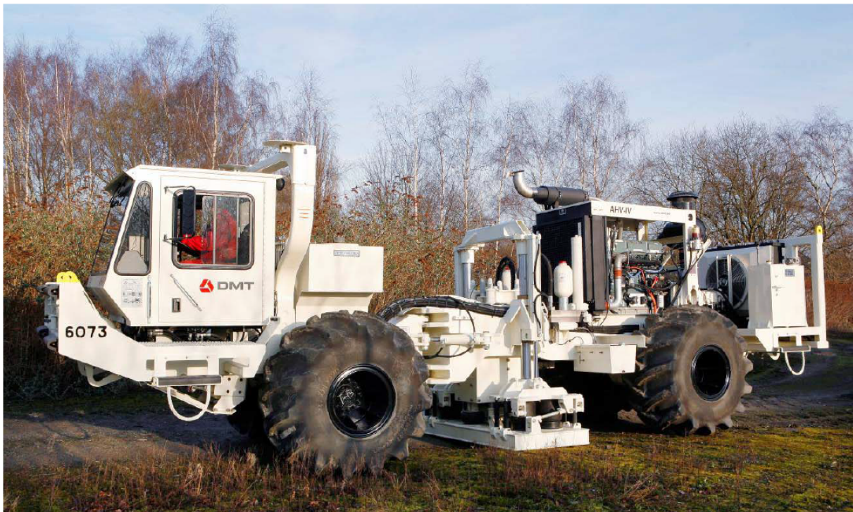
Abbildung 3: Beispiel Vibratorfahrzeug INOVA AHV IV mit der Vibratoreinheit PLS-362.
