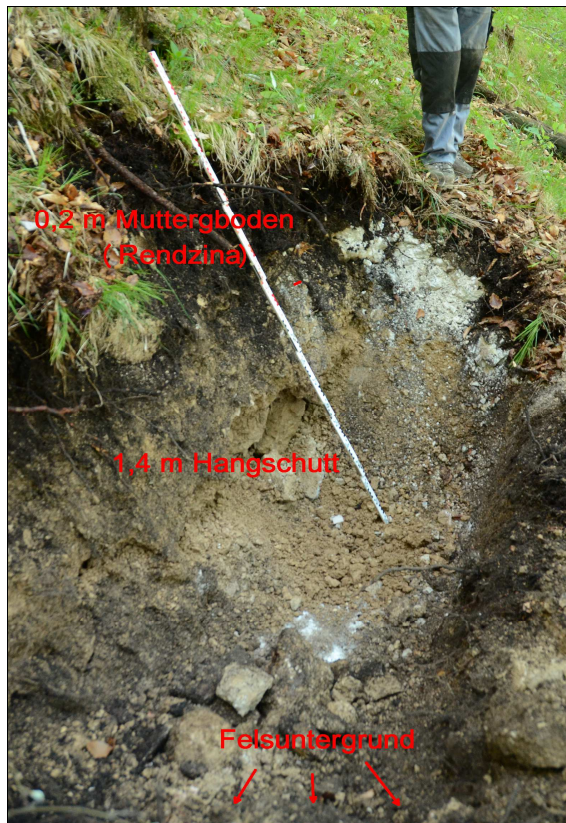
Abbildung 7: Foto Bodenaufschluss Schurf Nr. 2 mit Benennung der angetroffenen Bodenschichten
